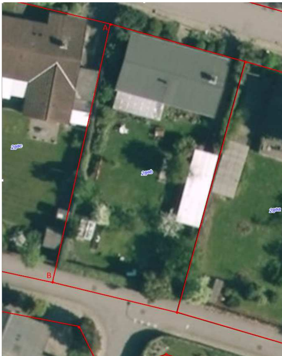
Figur 6: Udsnit af matrikelkortet for Sdr. Køge, Køge Jorder med ortofoto som baggrund.
