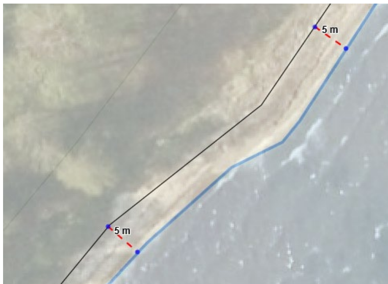
Figur 11: Eksempel på forskel mellem fysisk opmålt ejendomsgrænse på stedet (sort linje) og GeoDanmarks kystlinje (blå linje) med ortofoto som baggrund.
