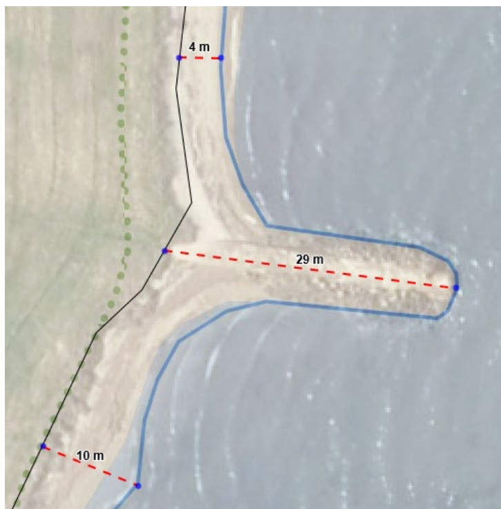
Figur 12: Eksempel på forskel mellem fysisk opmålt ejendomsgrænse på stedet (sort linje) og GeoDanmarks kystlinje (blå linje) med ortofoto som baggrund.
