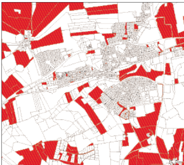
Figur 55. Udsnit af matrikelkort for Bjerringbro kommune. De med rødt markerede lodder tilhører matrikelnumre, der består af to eller flere lodder.
