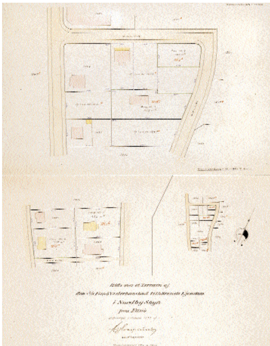
Figur 16. Hovedkort fra 1930. Et hovedkort er en kopi af matrikelkortet, hvorpå landinspektøren har angivet de nye skel og vist en konstruktion, som viser opmålingen. Målene er angivet med blå skrift.
