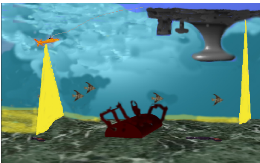
Fig. 8 Fordelen ved at bruge Side Scan Sonar er en bredere dækning af havbunden.
